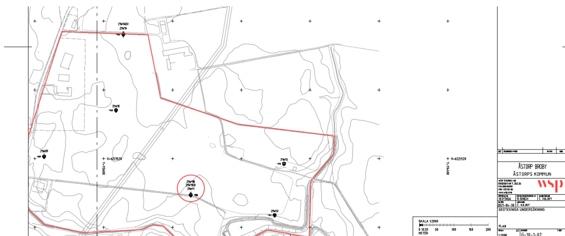
Figur 8. Placering av grundvattenrör inom planområdet för Broby 50:2. Källa: MUR Geoteknik och hydrogeologi Åstorp Broby (WSP, 2021).
