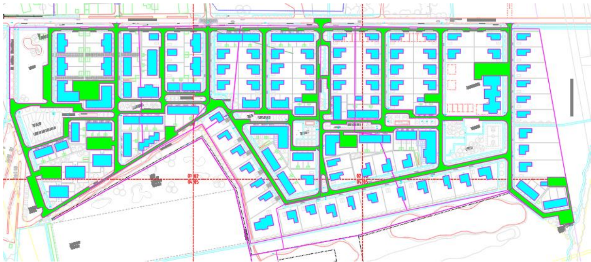
Figur 6 – Översiktsskarta över Lydinge villapark. Cyan färg avser tak, grön avser hårdgjorda ytor av asfalt och resterande ytor avser genomsläppliga ytor och tomter.
