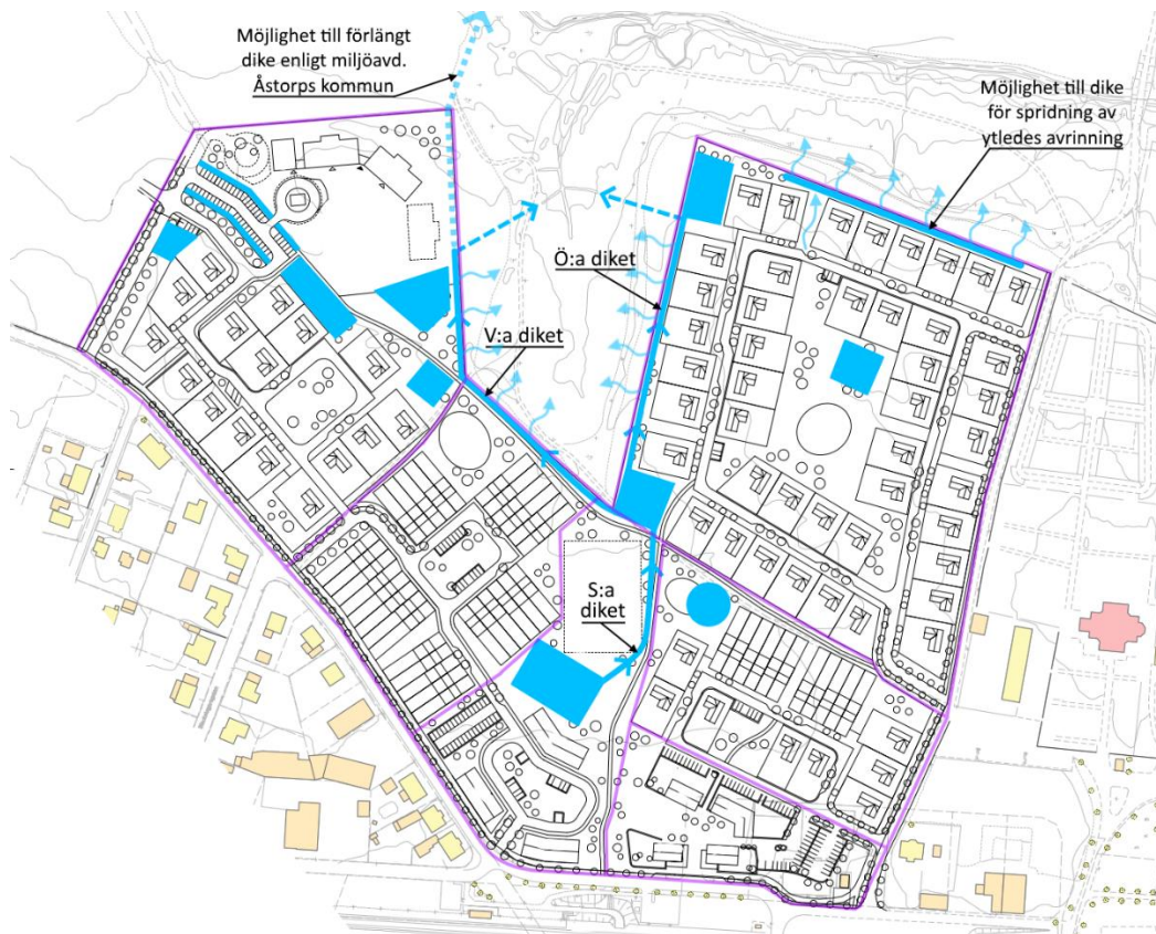
Figur 15 – Illustration över hur vatten från dikena bör fördelas vid skyfall för att minska koncentrerade flöden i naturreservatet
