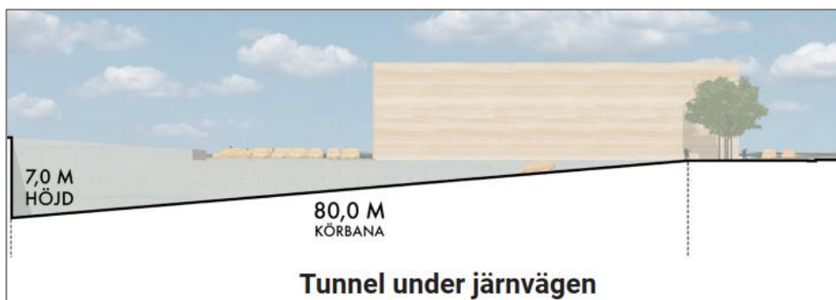
Figur 11. Illustrerad profil för vägport under järnvägen på norra sidan. Källa: Åstorps kommun (2022).
