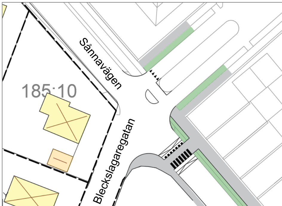
Figur 22. Principiell utformningsskiss för korsningen Sånavägen/Bleckslagaregatan
