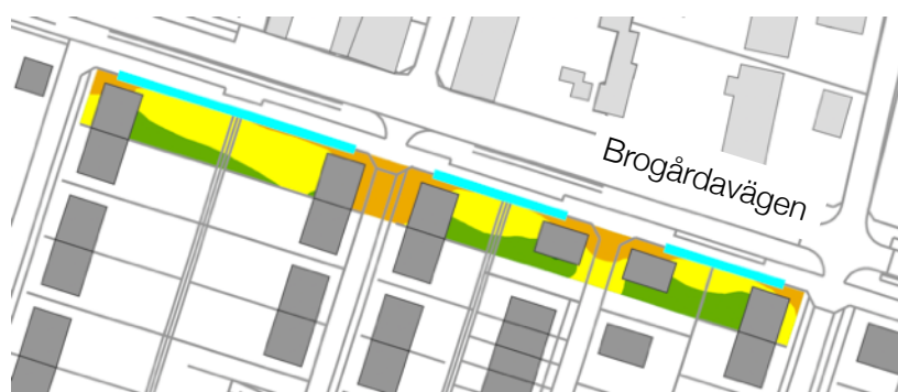
Figur 3. Ekvivalent ljudnivå bakom 1,2 m höga bullerplank (ljusblå linjer) i västra delen av området. Gröna ytor uppfyller riktvärdet 50 dBA för uteplats.
