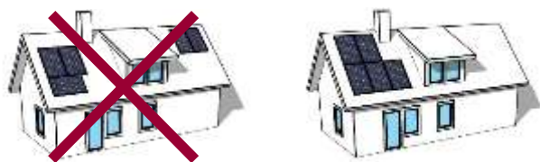
Exempelbild på enhetlig placering av solpaneler
